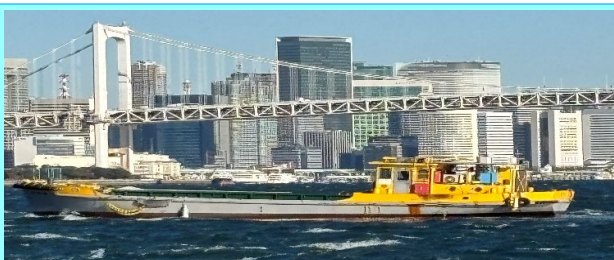
船名 第六清海丸 総トン数9.1トン 令和4年3月竣工 長さ10.9m 幅6.4m 深さ1.7m 馬力174ps×2基
