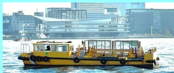
船名 第六清海丸 総トン数9.1トン 令和4年3月竣工 長さ10.9m 幅6.4m 深さ1.7m 馬力174ps×2基
