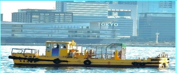
船名 第五清海丸 総トン数15.6トン 昭和54年12月竣工 長さ11.2m 幅5.5m 深さ1.7m 馬力230ps×2基
