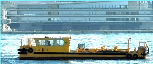
船名 第三清海丸 総トン数6.6トン 平成28年3月竣工 長さ10.7m 幅5.1m 深さ1.7m 馬力182ps×2基
