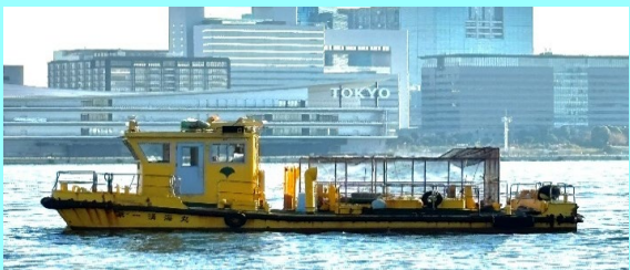
船名 第一清海丸 総トン数14.0トン 平成10年3月竣工 長さ12.0m 幅6.6m 深さ1.7m 馬力230ps×2基
