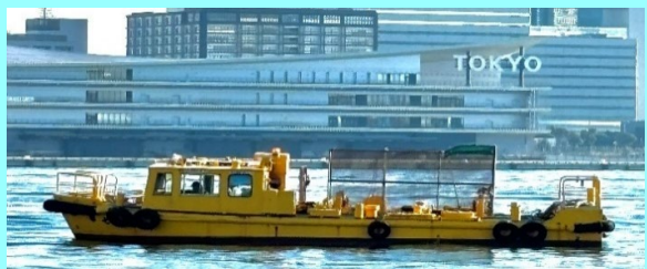
船名 第七清海丸 総トン数17.9トン 昭和55年3月竣工 長さ10.9m 幅6.4m 深さ1.6m 馬力150ps×2基
