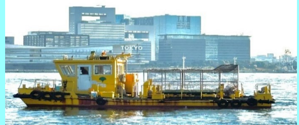
船名 第二清海丸 総トン数14.0トン 平成12年3月竣工 長さ12.5m 幅6.6m 深さ1.7m 馬力230ps×2基
