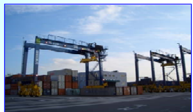
「トランスファークレーン」 ヤード内でコンテナの移動を行うクレーン
